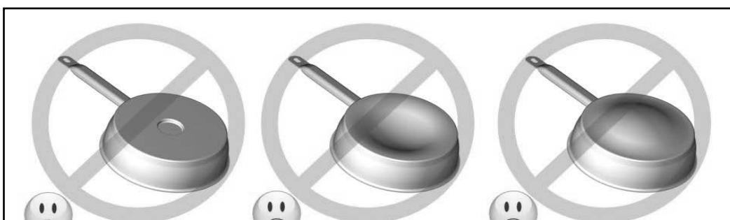
Sollte der Boden des Topfes ( $\varnothing d$ ) bedeutend kleiner als der Durchmesser des Körpers ( $\varnothing D$ ) sein, **führt dies zu einer Leistungsminderung, und der Topf könnte möglicherweise von der Kochplatte nicht erkannt werden.**
