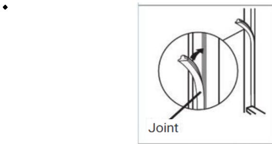
Terminer l'installation en appliquant le joint entre le réfrigérateur et le meuble du côté d'ouverture de la porte
