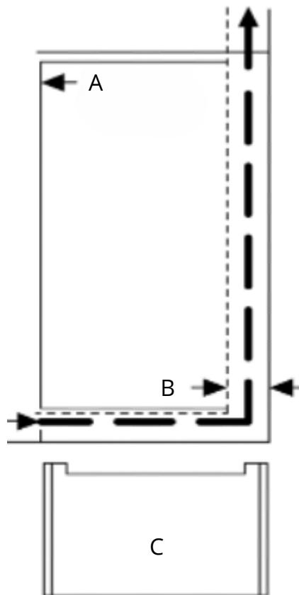
Pour le bon fonctionnement de l'appareil, il est important que la partie supérieure de l'unité ne soit pas obstruée. **En règle générale, plus l'air peut entrer et sortir, meilleur et plus efficace est le fonctionnement du produit.**
