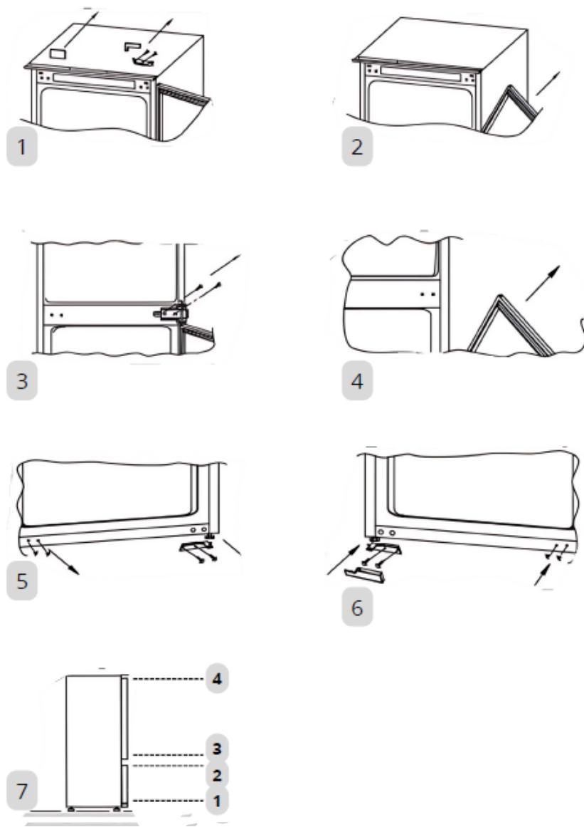
**1.** Dans la partie supérieure du réfrigérateur, retirer le couvercle des trous de la charnière et dévisser la charnière.
