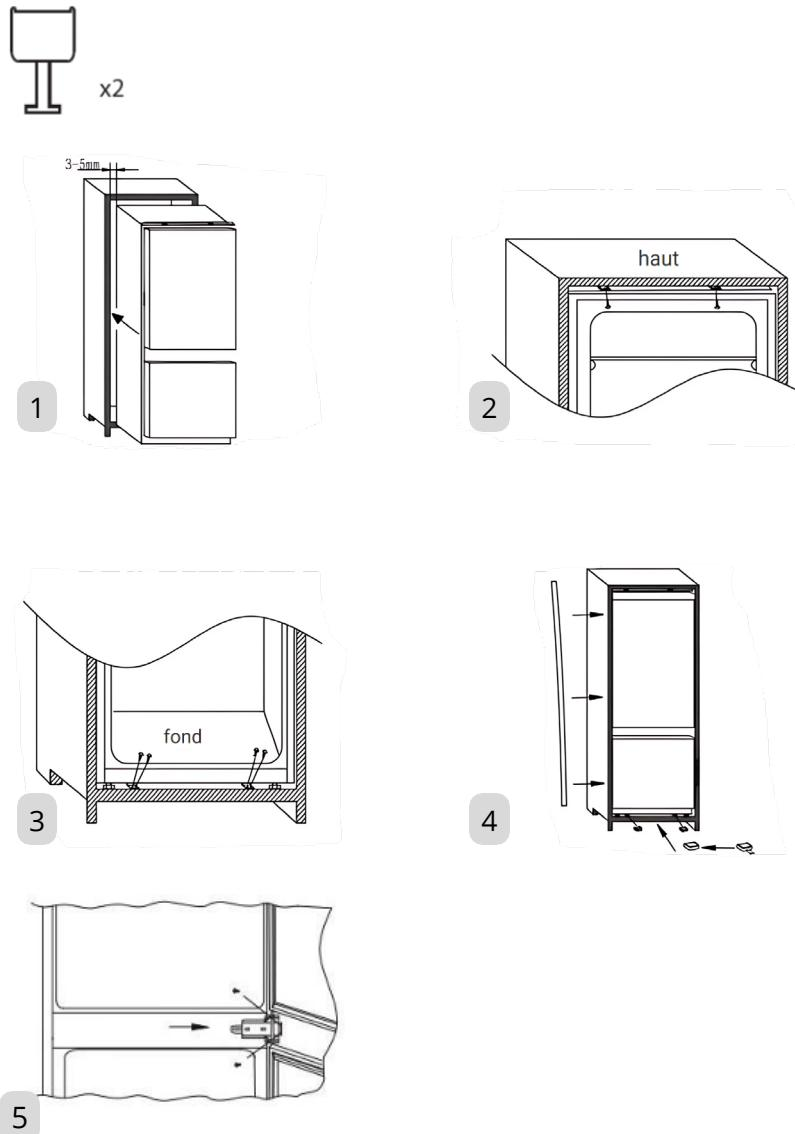
1. Placer le réfrigérateur à l'intérieur du meuble en laissant un espace de 3 à 5 mm entre la paroi de l'appareil et la paroi du meuble, du côté opposé aux charnières.
