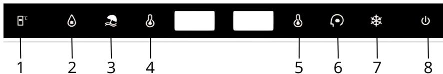
**1. Au premier allumage, cet appareil utilise toujours les paramètres : 5°C pour le réfrigérateur, 0°C pour la Cool Zone et -18°C pour le congélateur. Si vous souhaitez régler la température ou les fonctions manuellement, appuyez sur le bouton pour effectuer les opérations. Plages de température de la zone Cool Zone de - 3 ° C à 3 ° C.**
