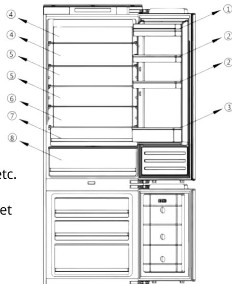
Les étagères du réfrigérateur peuvent être déplacées en fonction des besoins de conservation à l'intérieur de la section réfrigérateur. Pour déplacer l'étagère, soulever la seconde arrière, puis la tirer vers l'extérieur.
