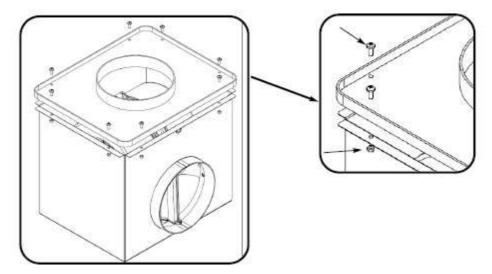
4 - Decidere da quale parte si vuole l'uscita dell'aria (anteriore, posteriore, laterale o inferiore).
