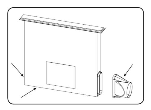
11 - Per bloccare la flangia con il raccordo applicare una vite nella parte superiore
