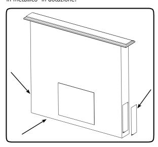
9 - Applicare il raccordo rettangolare in plastica per l'installazione del tubo laterale/inferiore utilizzando le stesse viti tolte in precedenza.
