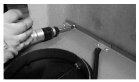
3 - Montare sulla parte aperta del motore una delle due placche in plastica utilizzando le n $^\circ\,$  8 viti e gli 8 dadi in dotazione.
