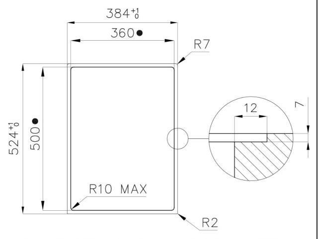
● Built—in cut out for FTS — Foratura per installazione FTS
